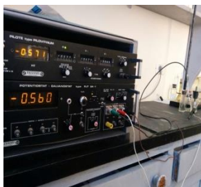
Figura 6. Potenciostati në gjendje pune.
